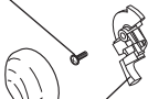
RP61272▲ Temperature Knob and Cover Perilla de la Temperatura y Cubierta Poignée de Réglage de Température
