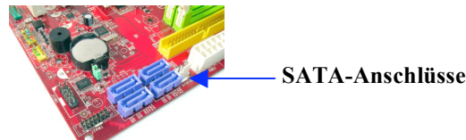
Abbildung 2: PC-Motherboard mit vier SATA-Anschlüssen. Die Anzahl der Anschlüsse variiert je nach System.
