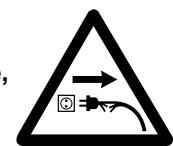
Vérifiez régulièrement le bon état des câbles de rallonge et changez-les s'ils sont détériorés. Maintenez les poignées sèches, propres et exemptes d'huile et de graisse.
