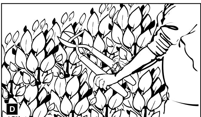
No intente cortar ramas de diámetros mayores de 16 mm (0,6") con este cortasetos. Estas ramas deben cortarse con una podadora (fig. D) hasta la altura realizada con el cortasetos.
