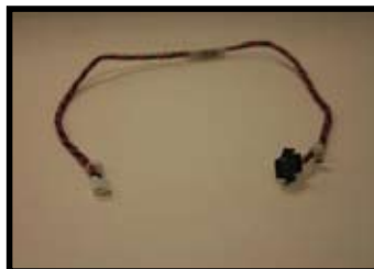
Cable 6 – Fan Cable 2
