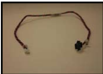
Cable 5 – Fan Cable 1
