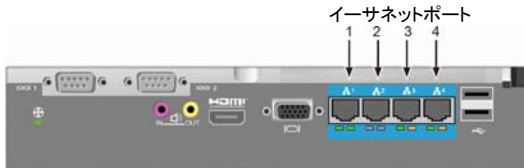
図 14: Vess A2600 後部パネルのイーサネットポート
