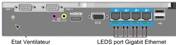
Figure 22: Panneau de contrôle LEDs
