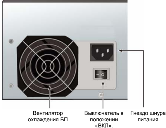
Рисунок 16: Разъем питания на задней панели Vess A2600s
