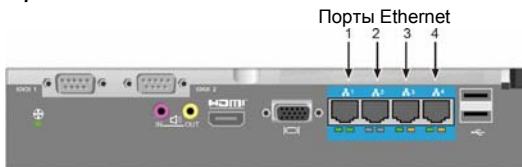
Рисунок 14: Порты Ethernet на задней панели Vess A2600
