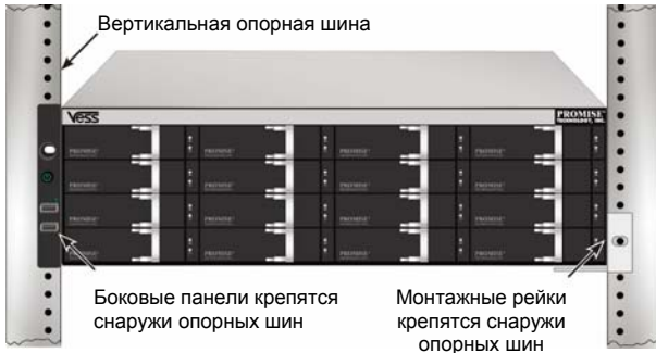
Рисунок 10: Система, смонтированная в стойке
