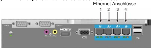
Abbildung 14: Ethernet ports an der rückseite des Vess A2600
