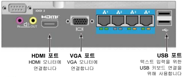
그림 15: Vess A2600 비디오 모니터 연결 및 USB 포트
