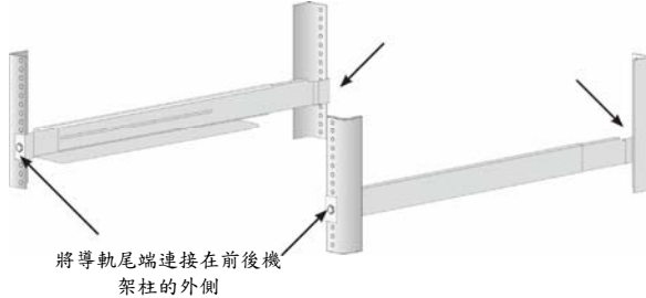
圖 7：將導軌尾端連接在每支機架柱的外側
