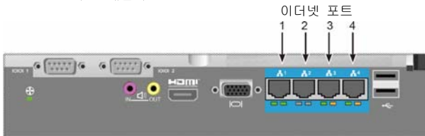
그림 14: Vess A2600 후면 패널의 Ethernet 포트
