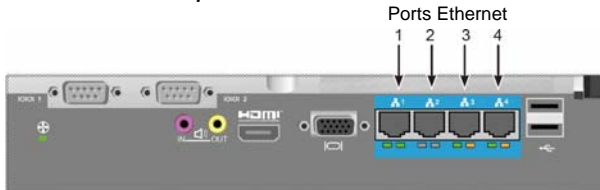
Figure 14: Ports ethernet sur le panneau arrière du Vess A2600
