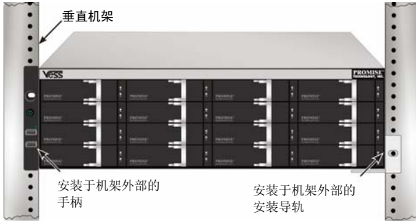
图 10: 已在机架上安装的系统
