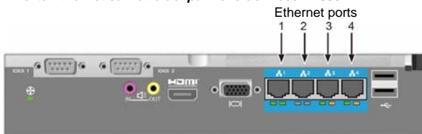
Figura 14: Porte Ethernet sul retro del pannello del Vess A2600
