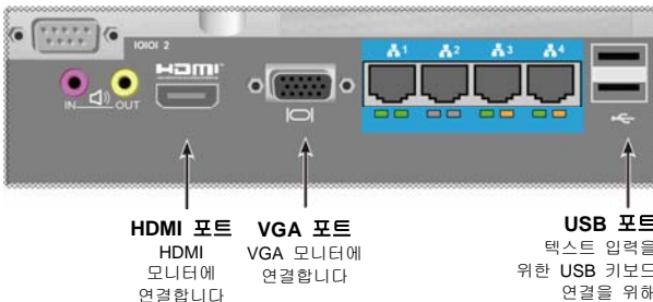
그림 23: Vess A2600 후면 패널의 USB, HDMI 및 VGA 인터페이스
