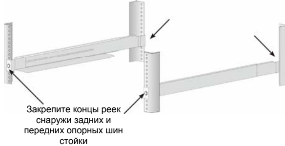
Рисунок 7: Крепление концов реек снаружи опорных шин
