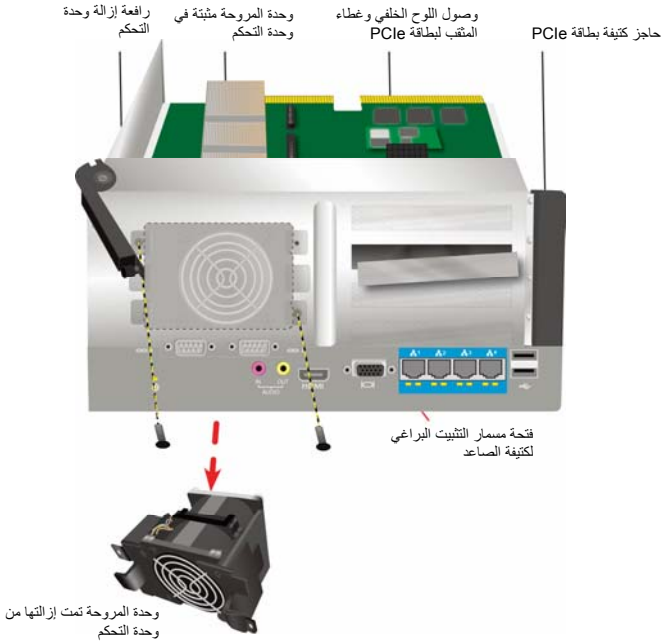
الشكل 32: إزالة المروحة من وحدة التحكم لجهاز Vess A2600
