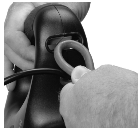
Figure 3-2 : Insertion de la boucle de la rallonge électrique dans la partie inférieure de la poignée
