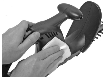
Figura 4-1: Limpieza de la carcasa de la podadora
