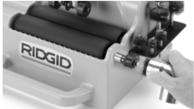
Figura 9 – Limpieza del interior de un fitting
