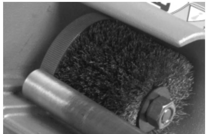
Figura 7 – Eliminación de las rebabas externas del tubo
