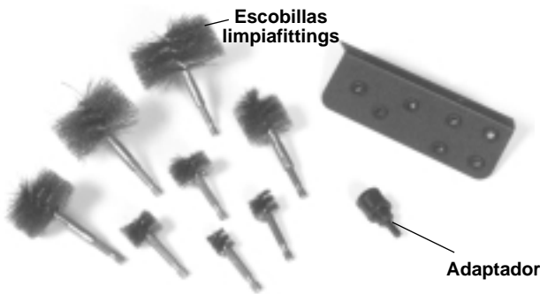
Figura 2 – Escobillas limpiafittings, adaptador para el rápido quita y pon de escobillas y el portaescobillas
