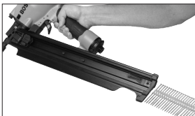
1. Chargez les clous. Maintenez la cloueuse et le magasin inclinés vers le bas. Insérez une barrette de clous.
