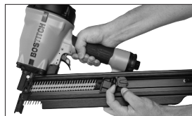
3. Faites glisser le pousser vers l'avant jusqu'au contact du dernier clou.
