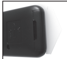
Fig. 3a-Languette isolante de pile de télécommande (enlever)
