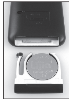
Abb. 3b-Batteriefach der Fernbedienung (geöffnet)
