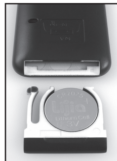
Fig. 3b-Sede pile telecomando aperta
