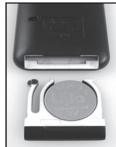
Fig. 3b- Compartimento de bateria do controle remoto aberto
