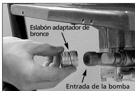
Figura 5 - Conecte el eslabón adaptador a la bomba
