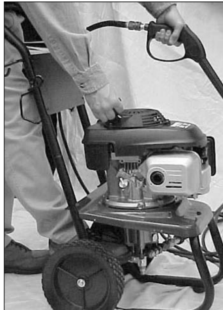
Figure 11 - Démarrage du moteur
