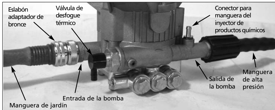
Figura 2 - Conexión de la bomba
