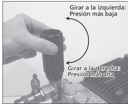
Figura 11 - Ajuste de la presión de la bomba de árbol de distribución
